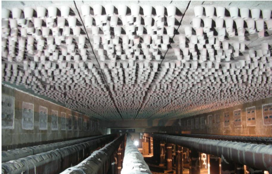
图 1 黑体元件布置示意图
