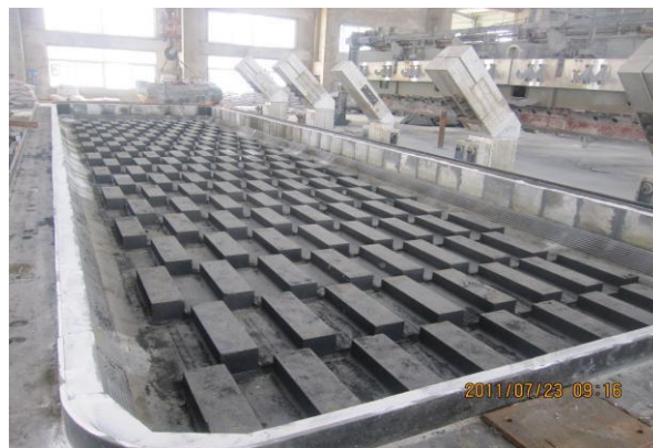
图 2 阴极碳块的上表面具有相互交错的横向凸起的电解槽
