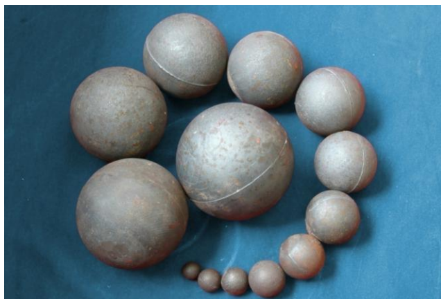
图 2 新型铬锰钨系抗磨铸铁磨球外观图
