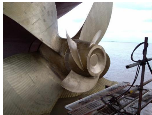
图 3 消涡鳍示意图
