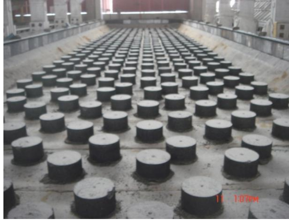
图 3 阴极碳块上表面具有交错的柱状凸起结构的电解槽
