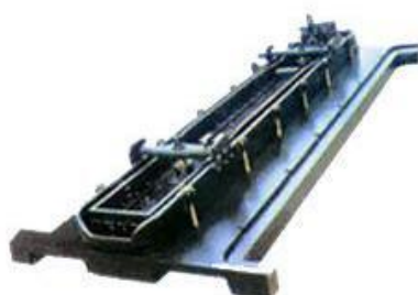
图2 挂釉焦炉炉门
