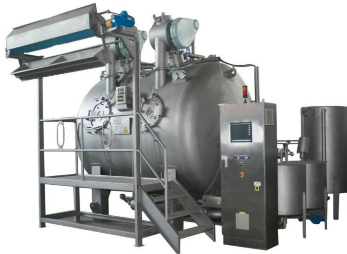
图 1 高温低浴比 O 型染色机装备示意图
